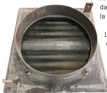
Les économiseurs sans condensation fonctionnent selon un processus élémentaire d'échange de chaleur. Ils se composent généralement d'un mécanisme d'échange de chaleur sous forme de serpentins ou de tubes à ailettes installés dans la cheminée. Lorsque les gaz d'échappement chauds traversent ce mécanisme, la chaleur est transférée aux serpentins ou aux tubes à ailettes. La chaleur ainsi captée sert à chauffer l'eau d'alimentation entrant dans la chaudière.
