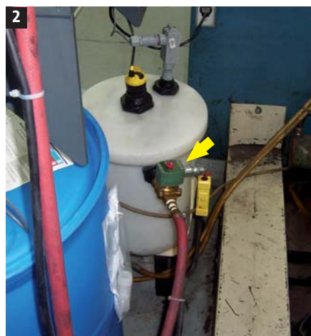
La flèche mauve indique le mélange des 3 produits vers le bassin mélangeur.
