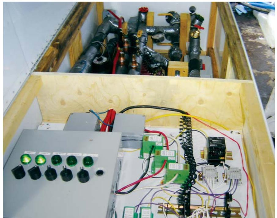
*Un appareillage mécanique et électronique sophistiqué enregistre tous les paramètres du forage. Sur ce chantier, la valeur de conductivité thermique K du sol a été établie à 1,67 btu/°F/pi. C'est à partir de cette valeur et des autres caractéristiques du terrain que les ingénieurs effectuent des simulations et déterminent le type d'échangeur géothermique qui convient le mieux.*
