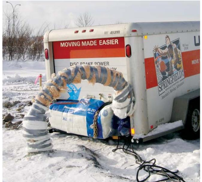
*Les forages illustrés ici permettent d'évaluer la conductivité thermique du sol pour des puits verticaux de 30 à 180 m de profondeur.*
