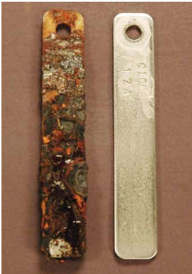
Le coupon de corrosion de droite atteste l'efficacité de l'inhibiteur de corrosion volatil ICV sur un élément de tour de refroidissement en un milieu humide.
