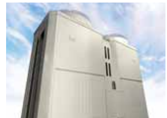
La pompe à chaleur air-eau monobloc Ecodan de Mitsubishi Electric. Compresseur inverter à vitesse variable, technologie injection flash diphasique, 45 kW (153 MBH) en mode priorité COP, jusqu'à 75 kW (255 MBH) en mode puissance et température d'eau jusqu'à 70 °C (158 °F)
