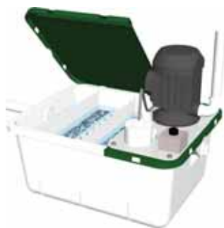
Le bac de 18 L de neutralisation de condensat NT25-P a une capacité de 150L/h et sa pompe une capacité de relevage vertical de 22 pi.
