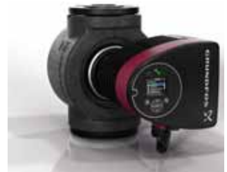
Le circulateur MAGNA 3, en fonte ou inox, à vitesses variables est le plus évolué sur le marché. 570 gpm et 75 % moins d'énergie. Les contrôles FlowAdapt et FlowLimit peuvent souvent éviter l'équilibrage.
