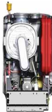
La chaudière murale à condensation Eco King Supreme, à taux de modulation 6:1, contient une valve à gaz auto-adaptative, un circulateur Grundfos et un réservoir d'expansion intégré. Un modèle combiné produit l'eau chaude sanitaire.
