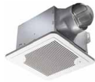
Le Delta BreezSmart 130 cfm à <0,3 sones à 0,1" pression statique, à moteur CC, à détecteur de mouvement et à délais de temporisation réglables (aussi en version Constructeur).
