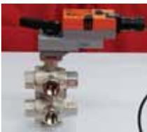
Conçue pour rencontrer les exigences les plus élevées en matière de régulation des systèmes en mécanique de bâtiment, la nouvelle vanne de contrôle à 6 voies modulantes apporte précision et performance à tous les systèmes à poutres climatiques (chilled beam). De plus, avec son seul servomoteur intelligent, elle économise 50 % des besoins en sorties de contrôleur pour les installations DDC.
