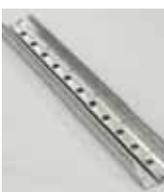
Le système de support TOP08-22 est un profilé fabriqué d'acier galvanisé G90 jauge 22, facilitant l'installation de conduits de ventilation et autres.
