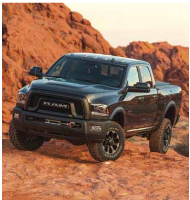
Le Ram 2500 Power Wagon ouvre son capot à un V8 de 6,4 L (410 ch, 429 lb-pi). La dimension des pneus est 285/70R17 et la garde au sol est de 36,3 cm (14,3 po).
