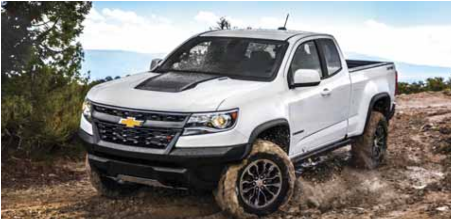
Le Chevrolet Colorado ZR2 est une camionnette intermédiaire mue par un quatre cylindres turbo diesel Duramax de 2,8 L (181 ch, 369 lb-pi) ou un V6 de 3,6 L (308 ch, 275 lb-pi). La garde au sol est de 26,2 cm (10,3 po).
