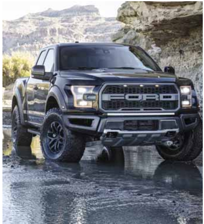
Le Ford F-150 Raptor est propulsé par un V6 biturbo de 3,5 L (450 ch, 510 lb-pi). La taille des pneus est 315/70R17 et la garde au sol atteint 29,1 cm (11,5 po).
