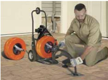
de 3 à 10 po de diamètre mesurant jusqu'à 200 pi. Le changement des tambours est facile et l'ajout de câbles supplémentaires est exécuté en quelques minutes.
