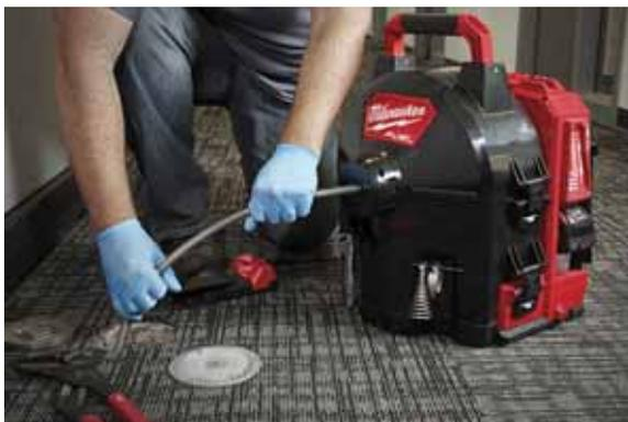
appareils les plus polyvalents et mobiles du marché, il permet aux utilisateurs d'échanger des tambours de différentes tailles. Son bloc-piles REDLITHIUM permet de réaliser plusieurs tâches avec une seule charge. Facilement transportable grâce à des bretelles de sac-à-dos intégrées, il est doté d'un frein à tambour intégré.
