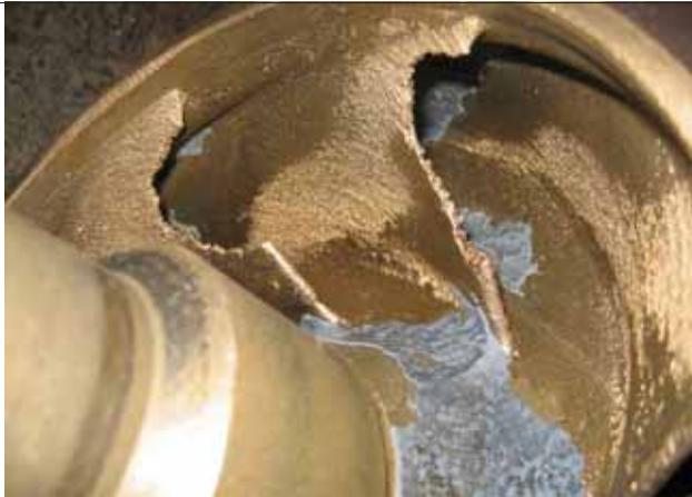
Figure 2 : Détérioration d'une pompe engendrée par la cavitation.
