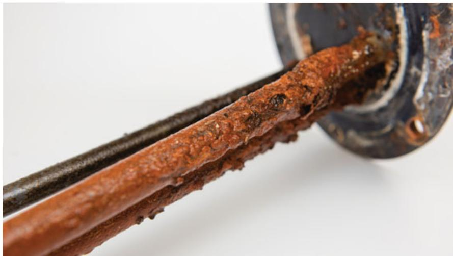
l'inverse, une eau douce est corrosive; elle attaque les tuyaux métalliques ainsi que les soudures.
