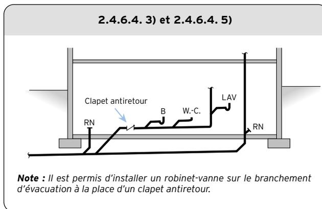
**2.4.6.4. 4)** Lorsque l'appareil à protéger selon l'article 2.4.6.4. 3) est un avaloir de sol, il est aussi permis d'installer un bouchon vissable en amont du siphon pour pallier l'exigence de l'article 2.4.6.4. 3). Cette application est principalement constatée aux avaloirs de sol installés dans certaines installations.
