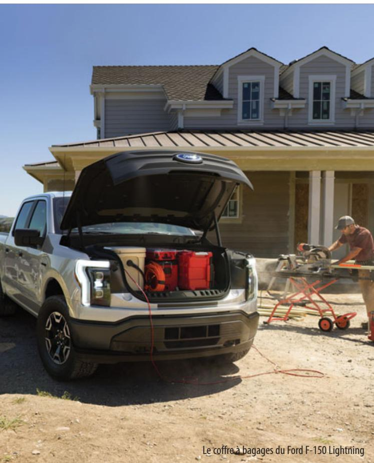
Pour alimenter les chantiers de construction en électricité, le F-150 Lightning peut être équipé d'une génératrice Pro Power Onboard de 2400 ou 9600 watts.
