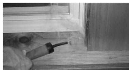
Le crayon fumigène permet de visualiser l'importance relative des infiltrations d'air et parfois d'en découvrir à des endroits qu'on n'aurait jamais soupçonnés.
