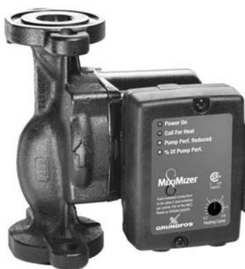
Au cœur du système, se trouve un contrôle électronique qui voit à ce que la quantité d'énergie injectée dans le plancher radiant égalise les pertes de chaleur du bâtiment. Quand la température descend, le *Miximizer* accélère la pompe, injectant ainsi plus de chaleur dans le réseau de distribution; quand la température remonte, il ralentit la pompe, injectant alors moins de chaleur.
