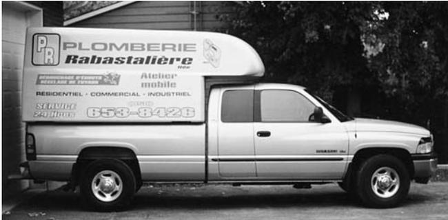
La cabine aérodynamique monocoque de fibre de verre, dont une version est munie de son propre plancher, est conçue comme un véritable coffre à outils dont la durée de vie est supérieure à celle du véhicule. Il faut donc comprendre que lorsqu'il sera temps de
