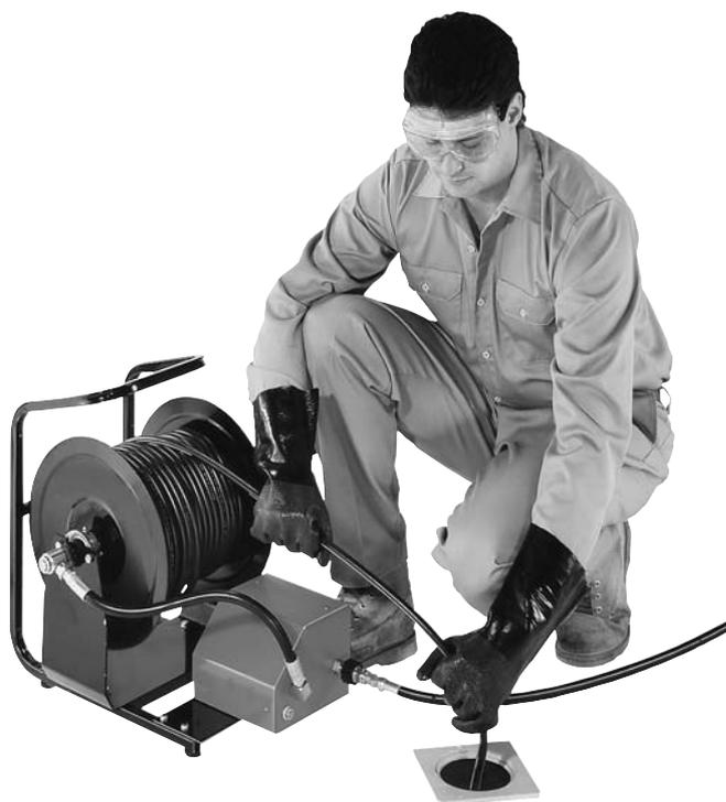
*Il est fortement recommandé de toujours porter des verres protecteurs et des gants (à plus forte raison avec les machines à câble) durant le fonctionnement d'un débouche-conduite. Ici, l'utilisateur a recours à un dévidoir optionnel, ce qui permet de laisser le moteur à essence à l'extérieur du bâtiment sans réduire la portée du boyau. Sur ce dévidoir, une pédale contrôle le débit d'eau pour laisser les 2 mains libres.*
