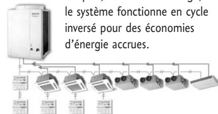
De plus, en mode chauffage, le système fonctionne en cycle inversé pour des économies d'énergie accrues.
