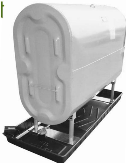
*Un modèle de bac de rétention est conçu pour les nouveaux réservoirs, c'est à dire qu'on installe le réservoir directement dans le bac, les pattes reposant sur une plaque métallique pour ne pas abimer le fond.*
