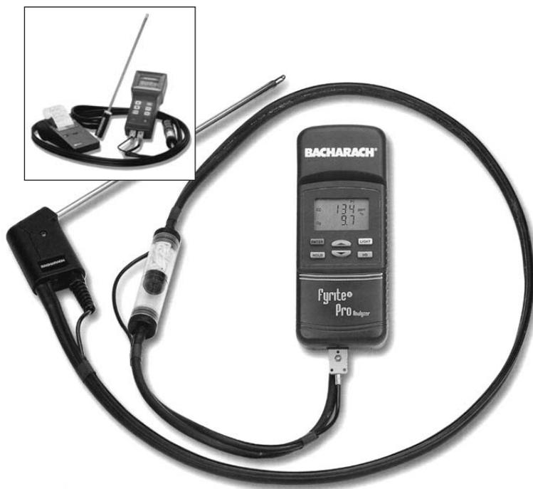
Les analyseurs de combustion électroniques sont les multimètres les plus adaptés aux appareils de chauffage de dernière génération. De plus, on peut les relier à une imprimante pour consigner le relevé des données dans le dossier-client ou pour montrer aux clients le résultat des ajustements effectués.
