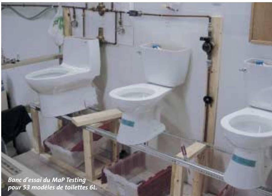
Banc d'essai du MaP Testing pour 53 modèles de toilettes 6L.
