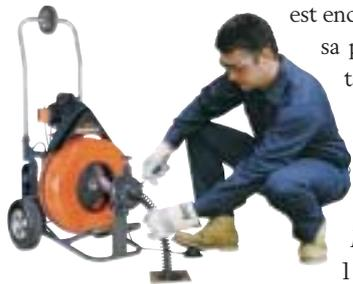
Ils transmettent toute la puissance de son moteur de 1/2 hp. L'alimentation de câble à ajustement automatique peut prendre des câbles de 3/4, 5/8 ou 1/2 po. Le changement de câble se fait en moins de 1 minute sans outil spécial; il n'y a qu'à faire pivoter le moteur et à libérer le tambour. On ajuste le type de câble au moyen d'un bouton sur le dessus du tambour au travers duquel on peut voir la quantité de câble restante.
