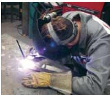
Afin d'améliorer la coloration de vos soudures, vous pouvez utiliser le gaz de protection *Specshield 2H* ou *5H* (de série 300). Ce gaz augmentera votre rendement et la qualité de vos soudures. Remplacez vos buses de soudage par des modèles *Gas Lens*, vos résultats seront remarquables. Utilisez également un jet d'air comprimé pour nettoyer vos joints soudés, ceci retardera la déformation.
