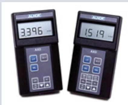
On peut utiliser les manomètres différentiels pour vérifier l'encrassement des filtres, pour mesurer des niveaux de liquides dans des contenants pressurisés, etc. Utilisés avec une plaque orifice, un tube de Venturi, etc., ils permettent de mesurer les débits dans les liquides. Utilisés avec un tube de Pitot, les manomètres différentiels permettent de mesurer la vitesse ou le débit d'un gaz.
