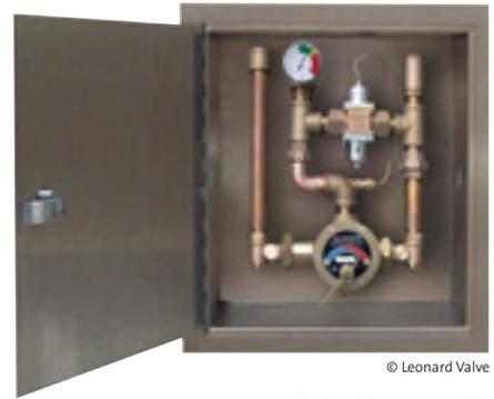
*Ce mitigeur à double cartouche thermostatique destiné aux douches déluges ou combinées contient plusieurs caractéristiques qui assurent un débit d'eau suffisant à des températures sécuritaires. La cartouche primaire ferme en cas de coupure d'eau froide et une dérivation permet de continuer à fournir de l'eau froide en cas d'interruption d'eau chaude. Il faut sélectionner un mitigeur capable d'assurer le débit requis selon le type et le nombre d'appareils à desservir.*
