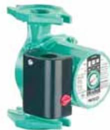
La gamme commerciale des circulateurs à rotor noyé de la famille **Wilo TOP S** pour le chauffage ou climatisation (fonte) et pour l'eau chaude sanitaire (bronze) assure des débits maxi de 270 galUS/min (17 L/s) et des hauteurs de charge de 52 pi (15,85 m). Les diamètres disponibles vont de 1 1/2 à 4".
