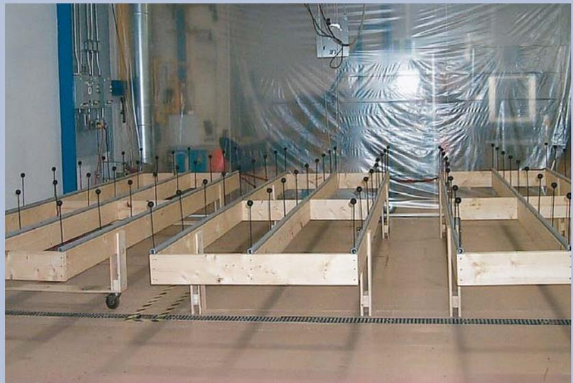
Le CTGN a développé son propre banc d'essai, dédié à la caractérisation des performances des équipements de chauffage infrarouge et à leur comparaison. Il s'agit d'une installation de 25 m<sup>2</sup>, présentée à la figure 2, qui comprend un ensemble de 81 sondes de température à globe noir, pour mesurer la température radiante, ainsi que 4 sondes de température standards, permettant de mesurer la température de l'air ambiant.
