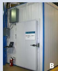
le mur de la pièce instrumentée muni de la fenêtre. Elle est reliée à une chambre de conditionnement par des conduits de ventilation isolés amenant l'air tempéré. Le tout fonctionne en configuration de type boucle fermée afin de faciliter le contrôle et de réduire au minimum les infiltrations d'air extérieur au système.
