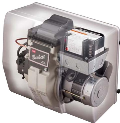
*Le brûleur Beckett NX est le plus avancé de ce fabricant américain. Bien qu'il ait été originalement conçu pour utiliser l'air de combustion de l'intérieur, on peut y brancher un conduit de prise d'air extérieur, ce qui peut limiter considérablement les pertes en attente. De 0,40 à 1,75 gph, 56 000 à 245 000 btu/h.*
