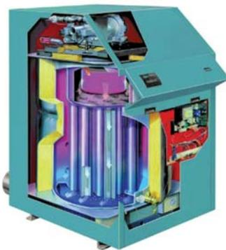
*La chaudière tubes à feu à configuration verticale, à condensation, Cleaver-Brooks CFC est offerte en 4 puissances de 750 à 1800 MBH, avec brûleur à vitesse variable, pleine modulation 5:1, silencieux (<70 dBA), à basse émission de NOx (<30 ppm) et 90 % d'efficacité. Une version horizontale CFH est également disponible pour applications eau chaude ou vapeur, haute ou basse pression.*
