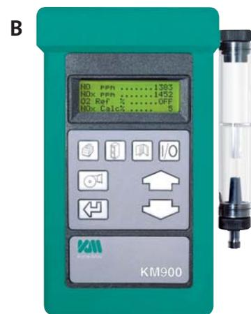
**2 analyseurs de combustion électroniques : A - pour des applications résidentielles, B - pour des applications résidentielles, commerciales et industrielles. Ces types d'appareils allient précision de lectures et plus grande productivité.**
