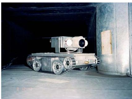
*Des mini-robots équipés d'une caméra sont fabriqués en différents formats pour convenir à la plupart des dimensions de conduits. Ils servent aussi à propulser les brosses ou autres équipements de nettoyage.*
