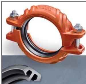
Le raccord de fonte, composé de 2 demi-anneaux réunis par 2 boulons est offert dans les formats de 2 à 6 po pour des tuyaux rainurés. Une garniture EHP intérieure, garantie jusqu'à 250 °F, assure l'étanchéité du raccord. L'ensemble a été reconnu pour la facilité et la rapidité d'assemblage.
