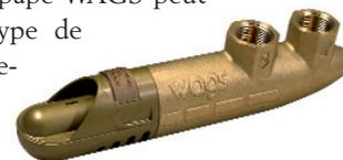
La soupape WAGS repose sur le fond d'un bac de récupération placé sous le chauffe-eau. Une accumulation d'eau de 7/8 po activera la soupape, l'eau et le gaz ou le mazout étant coupés instantanément. En l'absence de bac, une digue **WAGS Dam** peut remplir la même fonction. Une languette rouge surgit alors en signe d'activation. Ce dispositif ne peut être activé qu'une seule fois et ne contient aucun composant réparable.
