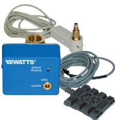
1. Le **FloodSafe Water Detector Shutoff** est un dispositif électromécanique qui protège contre les fuites ou les bris des chauffe-eau électriques, à gaz ou à mazout. Installé sur l'alimentation d'eau froide, la soupape arrête la distribution d'eau et coupe la source d'énergie à l'appareil. L'activation du dispositif se fait au moyen d'un détecteur d'eau
