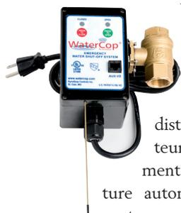
WaterCop est un système de fermeture d'eau automatique constitué d'un robinet à bille motorisé et de capteurs d'humidité émettant des signaux sans fil jusqu'à une distance de 200 pieds. Des détecteurs de température sont également disponibles pour une fermeture automatique en cas de gel. Les capteurs sans fil permettent une installation facile et économique en construction neuve et plus particulièrement en rénovation.
