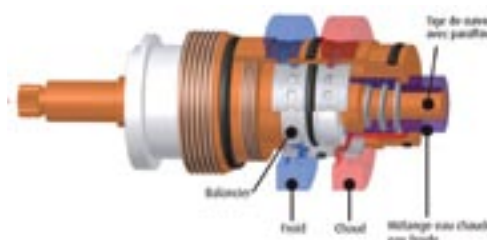
Cartouche thermostatique à pression équilibrée
