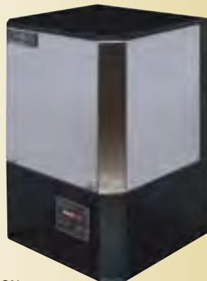
Caractéristiques principales: Efficacité de 96%. Allumage à étincelle. Évacuation en pvc, cpvc, ou polypropylène Centrotherm (jusqu'à 100 pi équivalent). Échangeur en inox 316. Bassin collecteur de condensé intégré. GN ou propane, applications chaudière, chauffe-eau ou combo (priorité DHW). Dégagez zéro des matériaux combustibles. Distribuée exclusivement via Emco/Deluxair.
