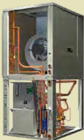
Pompe à chaleur géothermique à triples fonctions (eau-air-eau) produisant de l'air chaud ou froid ou de l'eau chaude à profusion. Excellent pour chauffer/climatiser un bâtiment muni à la fois de conduits de ventilation et de planchers hydroniques. Les modèles *TF* sont aussi idéaux pour chauffer piscine ou spa. Un désurchauffeur permet la production d'eau chaude domestique. Moteur
