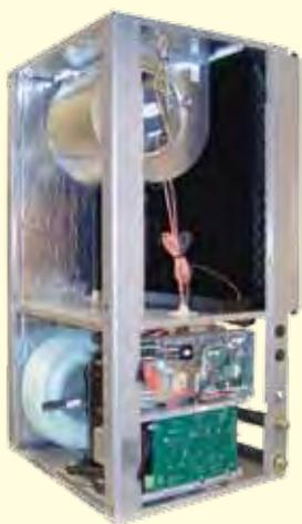
Thermopompe géothermique avec compresseur à vitesse variable. La capacité de cet appareil est toujours en fonction de la charge du bâtiment. Les temps d'opération sont nettement supérieurs pour un meilleur contrôle de température et d'humidité. Lorsque le compresseur fonctionne à basse capacité, la performance est optimisée par la grandeur de l'échangeur de chaleur (évaporateur et/ou condenseur). La pompe du circuit fermé est également à vitesse variable.
