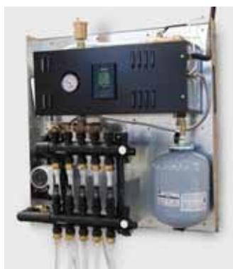
qu'à raccorder le thermostat, l'alimentation électrique et les circuits hydrauliques. L'ensemble comprend une chaudière électrique de 30 000 Btu/h, un collecteur de chauffage en plastique EP, un circulateur, un vase d'expansion, une soupape de décharge, des robinets d'isolement, un thermostat et un purgeur d'air, tous
