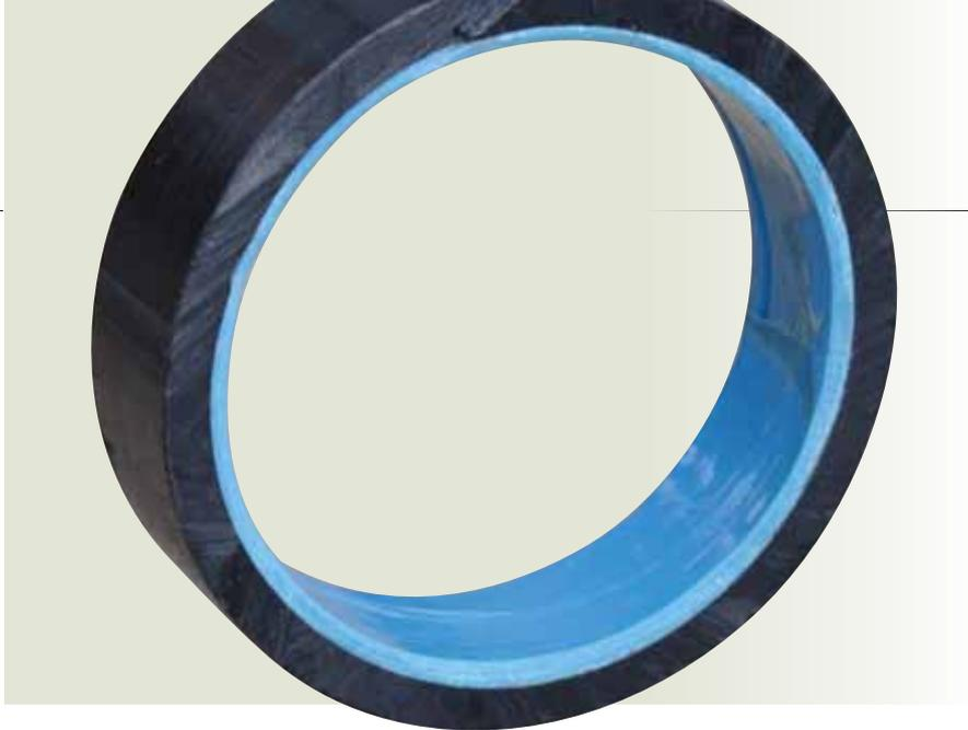
Coupe d'une conduite de 3 po réhabilitée. La gaine interne en fibre de verre, d'une épaisseur de 2 mm enlève à peine plus que 4 mm au diamètre original.
