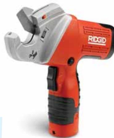
de l'outil. Une pile longue durée détachable de 12 volts au lithium-ion permet de faire jusqu'à 250 coupes par charge. Indicateur de niveau de charge et étui en plastique robuste.
