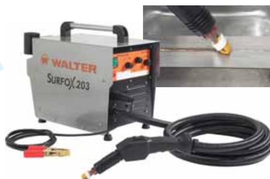
des pièces à traiter. Après l'électronettoyage, on applique une solution de neutralisation sur la surface pour éliminer les dépôts acides. Le système *Surfox* amélioré nettoie les surfaces à une vitesse de 3 à 6 pi à la minute. Le flot contrôlé de la solution nettoyante empêche aussi le gaspillage du liquide.
