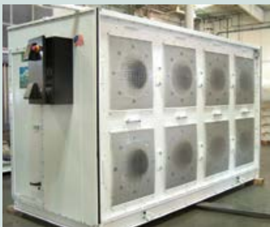
Un assemblage de 8 modules, vu de face, prêt à intégrer dans une centrale de traitement d'air.
