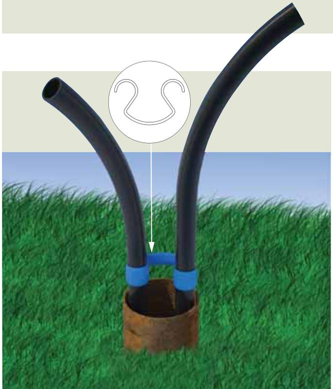
L'utilisation de tube à conductivité thermique supérieure et/ou d'entretoises, qui maintiennent le tube contre la paroi du puits, assure un meilleur transfert de chaleur et améliore le rendement d'un captage géothermique de façon significative.
