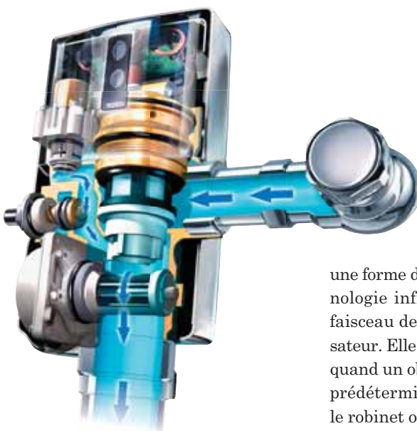
La micro-turbine EcoPower de TOTO utilise la puissance de l'écoulement de l'eau pour créer un courant électrique. Si le condensateur contient assez d'énergie pour les prochaines chasses d'eau, le courant généré servira à recharger la batterie.
