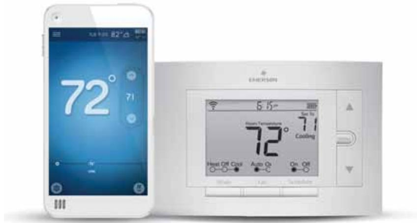
Le nouveau thermostat Sensi est géré par un téléphone intelligent ou une tablette à partir d'une application gratuite permettant de modifier la température à distance.
