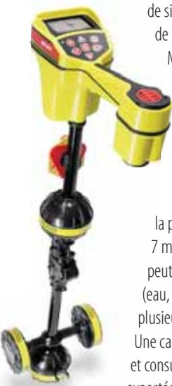
Muni d'un grand écran LCD, le SR-24 fonctionne avec l'application RIDGIDtrax qui exporte les trajectoires vers le logiciel GIS. En raccordant un périphérique Android via Bluetooth, RIDGIDtrax affichera la position et la profondeur (jusqu'à 7 m ou 23 pi) du réseau. L'utilisateur peut spécifier le type de réseau (eau, gaz, électricité, etc.) et afficher plusieurs réseaux sur une même carte. Une carte peut même être enregistrée et consultée depuis l'application ou exportée en tant que fichier .KML.
