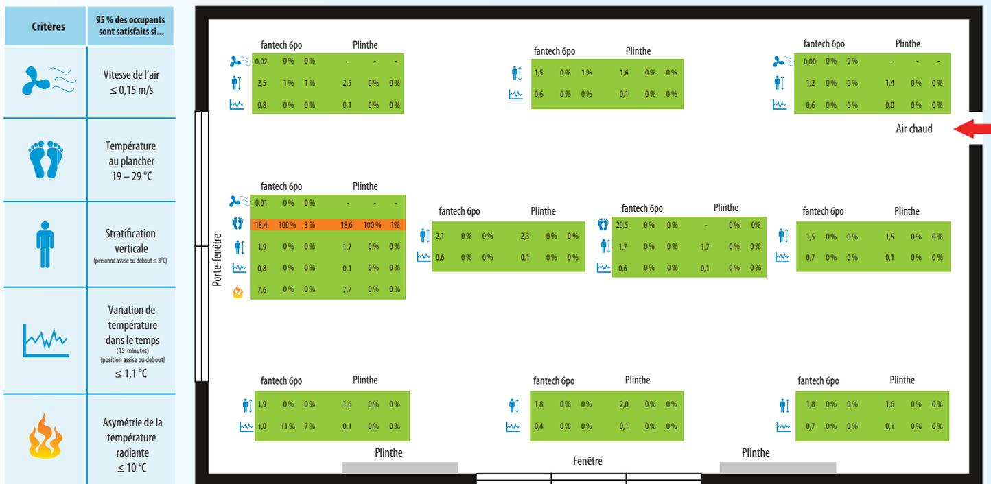
Analyse du confort – bouches à projection axiale de 15 cm (6 po) vs plinthes électriques en position assise.
