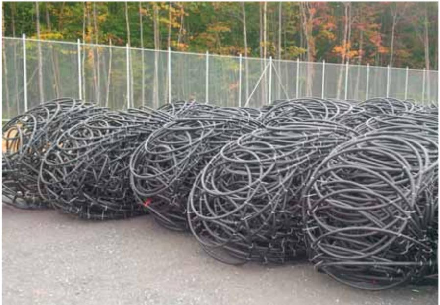
L'assemblage des rouleaux ainsi que la fusion des tubes ont été réalisés en atelier pour assurer la qualité du travail.
