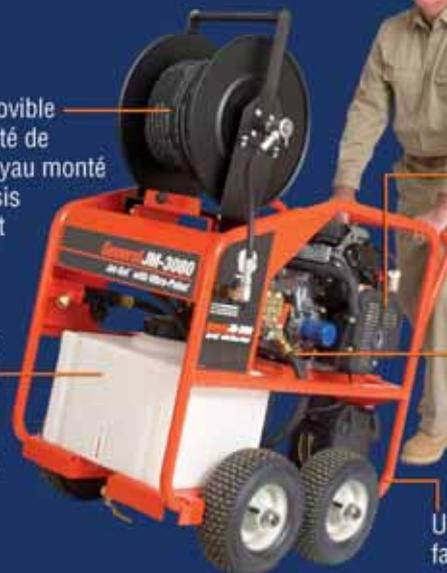
Moteur Honda de 20 hp (614 cc) propulse la pompe de 8 gpm/3000 psi avec démultiplicateur 2 : 1
