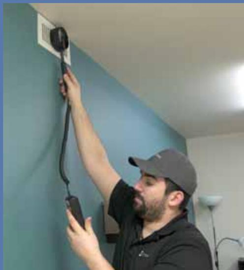
Un anémomètre à hélice réalise des lectures aux grilles (plafond, mur, plancher, etc.).
