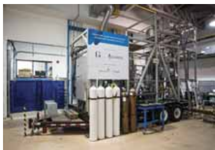
Unité de démonstration qui permet de transformer la biomasse forestière en gaz naturel.
