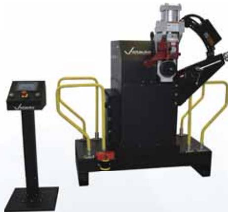
de la qualité de rainure tout en reproduisant fidèlement des rainures conformément aux spécifications afin d'assurer une installation initiale correcte des circuits de tuyauterie, éliminant les reprises de travaux dispendieuses et coûteuses en temps. Un détecteur de proximité intégré permet de maintenir un périmètre de sécurité autour de l'outil, assurant la protection des utilisateurs.
