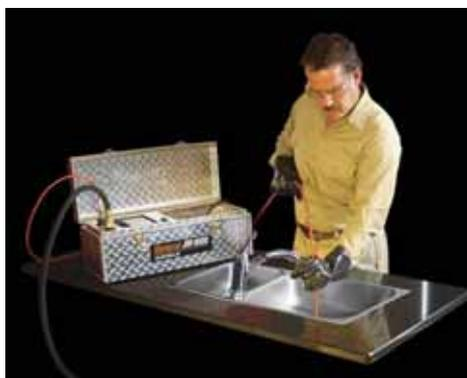
Compact et léger, le Mini-jet JM-1000 de General Pipe Cleaners permet de nettoyer facilement la graisse, les sédiments et la glace dans les conduites de 1 ½ à 3 po. Les jets d'eau projettent de l'eau à haute pression, dont l'impact est suffisant pour détruire et évacuer le bouchon. La force de propulsion du gicleur dirige le tuyau dans la conduite, pour un nettoyage complet, paroi à paroi.
