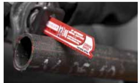
La lame de scie va-et-vient avec pointes au carbure permet de couper plus facilement et plus rapidement les métaux comme l'acier à haute résistance, la fonte, le fer noir et l'acier inoxydable. La durée de vie d'une lame à pointes au carbure est 20 fois plus longue que celle d'une lame bimétal régulière lorsqu'il s'agit de couper du métal d'une épaisseur de 3/16 po à 1/2 po.
