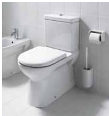
Cette toilette 2 pièces en porcelaine à installation pour évacuation murale est équipée d'une chasse double de 6 L (1,6 gallon) et de 4 L (1,1 gallon). Elle est munie d'un siphon direct de 3 1/2 po émaillé, d'un siège à fermeture lente et d'une garantie limitée de 5 ans.
