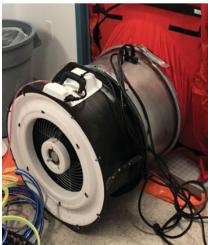
Réchauffeur d'air intégré au ventilateur de l'infiltromètre
