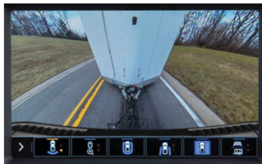
Le système de guidage avec vue à l'écran pour attacher l'attelage des camionnettes GM
