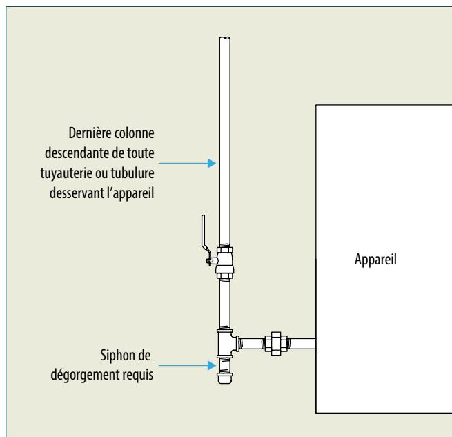
Sauf pour les exceptions prévues à l'article 6.13.1, il est donc nécessaire de prévoir l'installation d'un siphon de dégorgement sur la dernière colonne descendante desservant un appareil.
