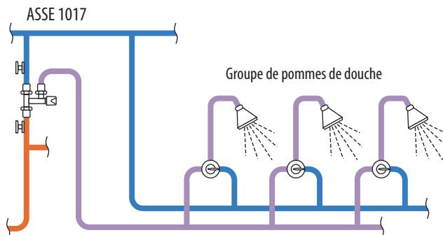
Puis, en consultant un tableau comparatif de certaines normes produites par l'ASSE, la norme qui vise les mélangeurs thermostatisques servant à alimenter des douches multiples à bouton poussoir est plutôt la norme ASSE 1069 *Performance Requirements for Automatic Temperature Control Mixing Valves*.
