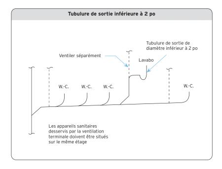
L'alinéa 2.5.3.1.1) c) stipule qu'aucune colonne de chute ne doit être raccordée au branchement d'évacuation **en amont** d'un appareil sanitaire ayant une ventilation terminale.
