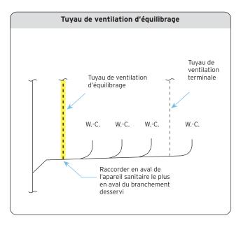
installé de concert avec le tuyau de ventilation terminale. La combinaison de ces deux tuyaux permet d'assurer une circulation adéquate de l'air. Tel que stipulé au paragraphe 2.5.3.1.3), le tuyau de ventilation d'équilibrage doit être raccordé **en aval de l'appareil sanitaire le plus en aval** du branchement d'évacuation.
