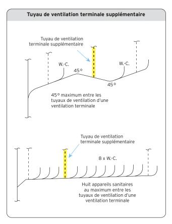
Un **tuyau d'évacuation d'eaux usées** peut être utilisé comme tuyau de ventilation terminale supplémentaire. Dans ce cas, il doit être conforme au paragraphe 2.5.3.1.7).
