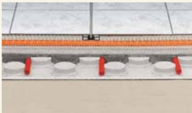
La géométrie du panneau à plots *Schlüter-BEKO-TEC-EN* permet d'obtenir une épaisseur de couche minimale de chape de 32 mm entre les plots et de 8 mm au-dessus des plots. Les plots sont conçus de sorte à permettre le calage de tubes de chauffage de 16 mm de diamètre avec un pas de 75 mm, pour la réalisation d'une chape chauffante.
